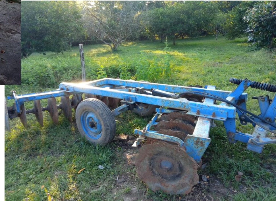
Figura 32. Rastra de discos (Disc harrow).
