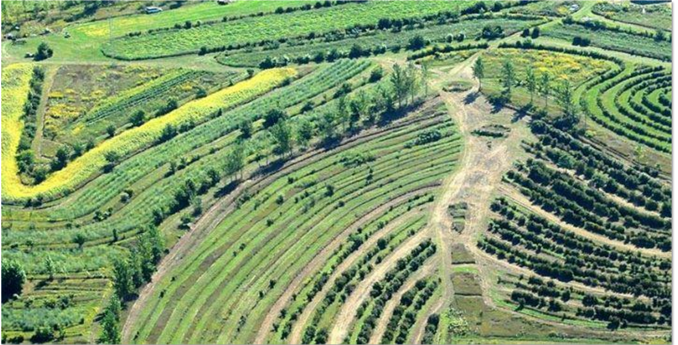
Figura 10. Diseño hidrológico del terreno con Keyline.
