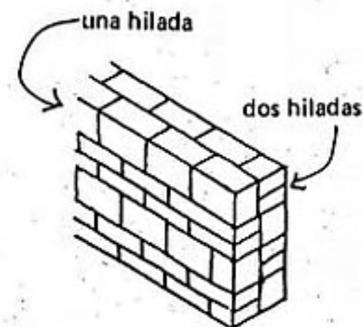
Corte de una pared que muestra un cambio en las hiladas
